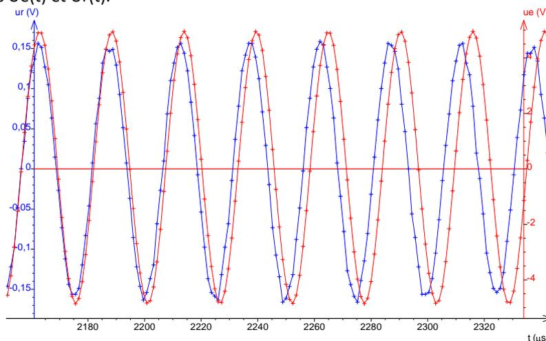
On détecte ainsi la différence entre les fréquences émises et reçues, on peut les comparer mais également réaliser la mesure des périodes sur ce graphe.
